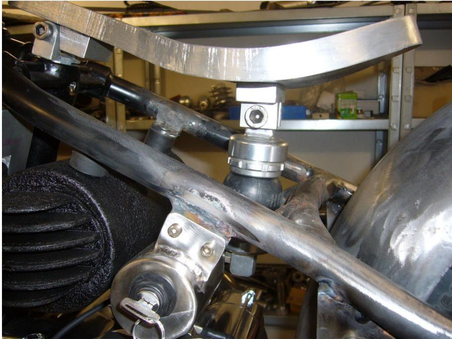
Bild 17 Sattel Alu Vollmaterial mit Luft-Feder-System
